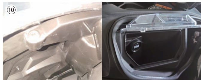
⑩ ストレージ内部、クリップ4カ所を外す。右サイドハッチのパッキングを外す。
