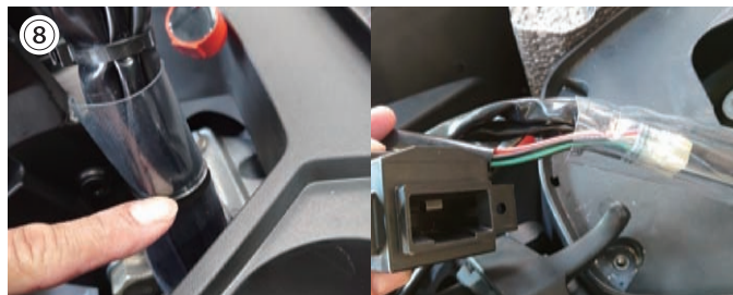
⑧ ハーネス、保護カバーのインシュロックを切り、イモビライザーユニットを取り外す。
