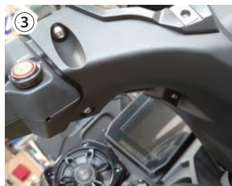
③ カバー取り付けボルト6カ所を外す。
