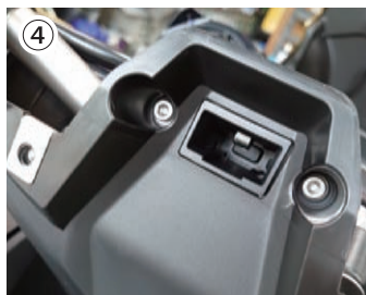
④ イモビライザー取り付けボルト2本を外し、カバーを取り外す。
