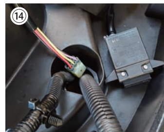
⑭ 取り付け後、イモビライザーユニットのハーネスは写真の穴から通す。 ※組付けは逆の手順にて行う。
