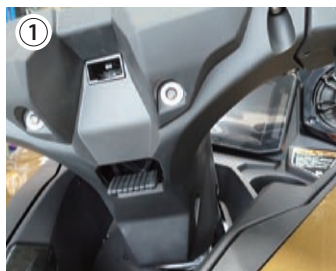
① バッテリー取り付けボルト2本を外しハットを外す。
