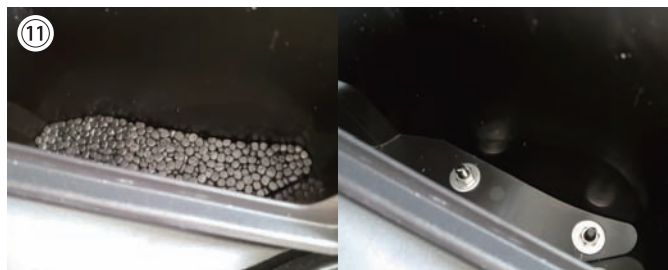
⑪ 防水ストレージ内部のバッテリー下にあるナット2カ所を取り外し、防水ストレージ本体を取り外す。
