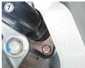
⑦ ハンドル右下にあるプレートとグロメット2本のボルトを取り外す。
